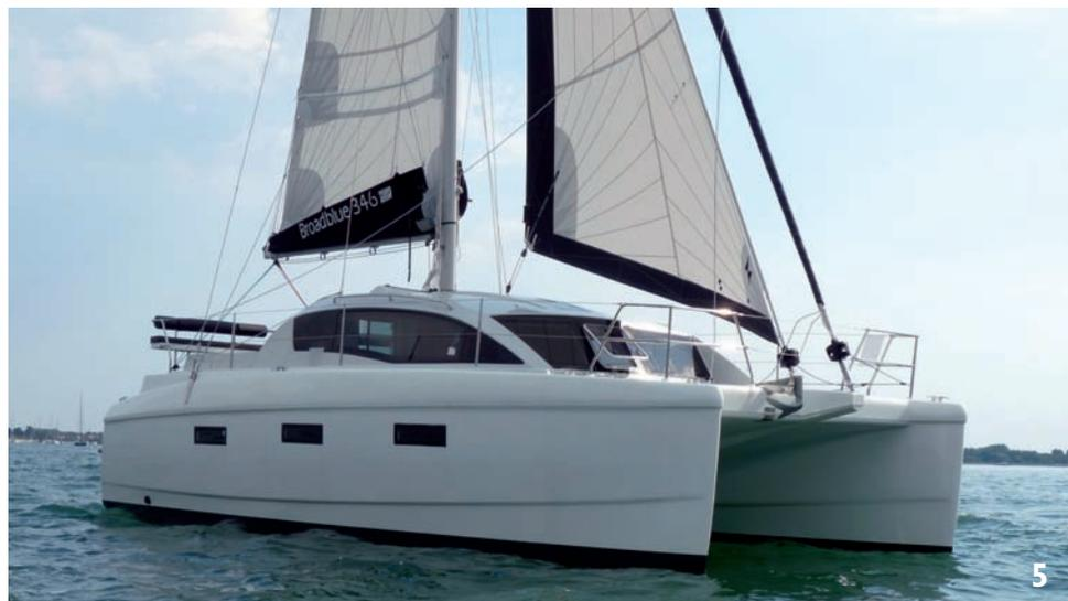
1 : Un gréement performant : mât pré-cintré avec triangulation sur un seul étage de barres de flèche, et un rond de chute généreux sur la grand-voile.
